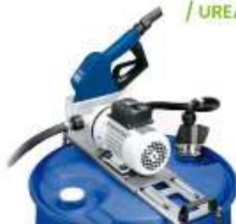
SUZZARABLU DRUM KIT F00201A1O DESPACHO DE HASTA 9 GPM 120 VOLTS BOMBA / PISTOLA AUTOMATICA CICLO 20 MIN ENCENDIDO / APAGADO AGUA / ANTICONGELANTE / UREA
