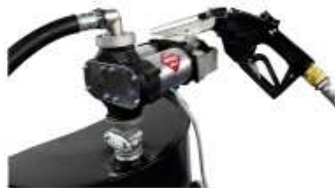
BIPUMP F003605A 12 VOLTS DESPACHO DE HASTA 25 GPM UNICAMENTE DIESEL CICLO DE 30 MIN ENCENDIDO / APAGADO 1" NPT
