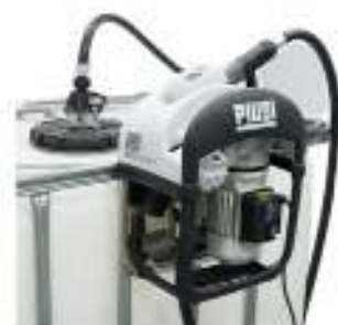
THREE25 F00101A1 DESPACHO DE HASTA 9 GPM 12 VOLTS PISTOLA CON MEDIDOR / FILTRO INCLUIDO CICLO 20 MIN ENCENDIDO / APAGADO AGUA / ANTICONGELANTE / UREA
